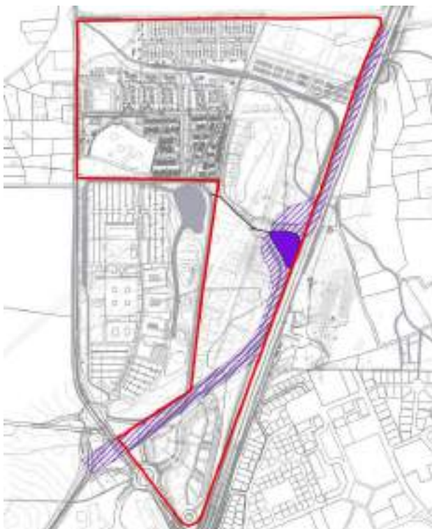
Figure 34 : surface contrôlée par le bassin de compensation de la voie de délestage rn5/rn11
